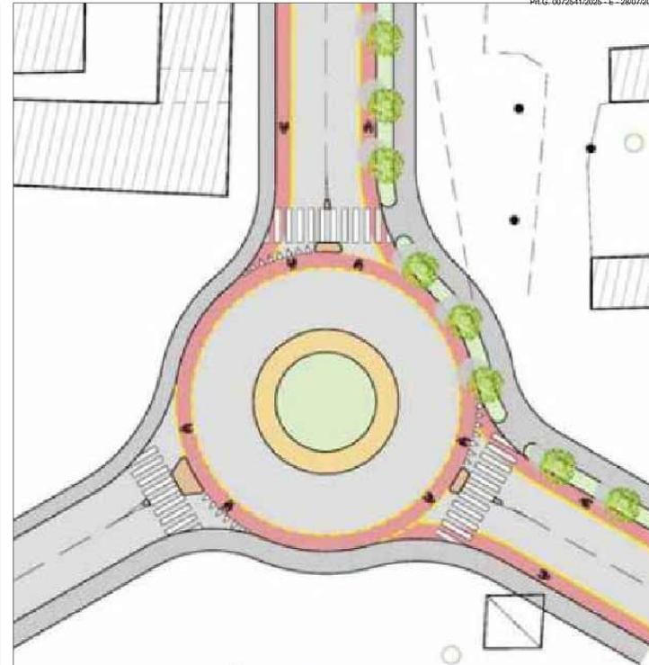
In corrispondenza delle rotatorie la pista ciclabile monodirezionale sarà ricavata all'interno della corona nella sede stradale mediante apposita segnaletica orizzontale.
